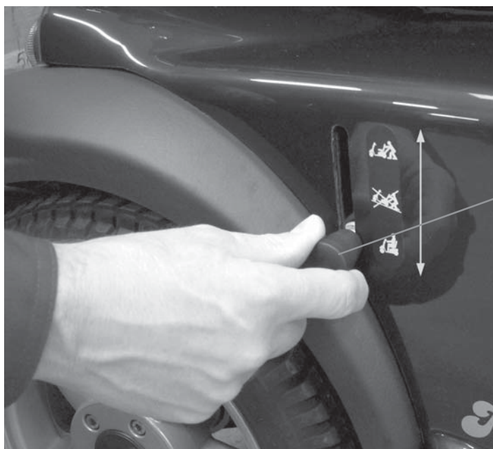
Figur 19 Skub håndtaget op frikobling, og køretøjet kan skubbes. Træk håndtaget ned for aktivering af motor. (Standardindstilling) Håndtaget skal trækkes op, når køretøjet skal skubbes. Når bugsering er tilendebragt, trækkes frikoblingshåndtaget ned igen. Nu er køretøjet bremsat og kan køre normalt.
