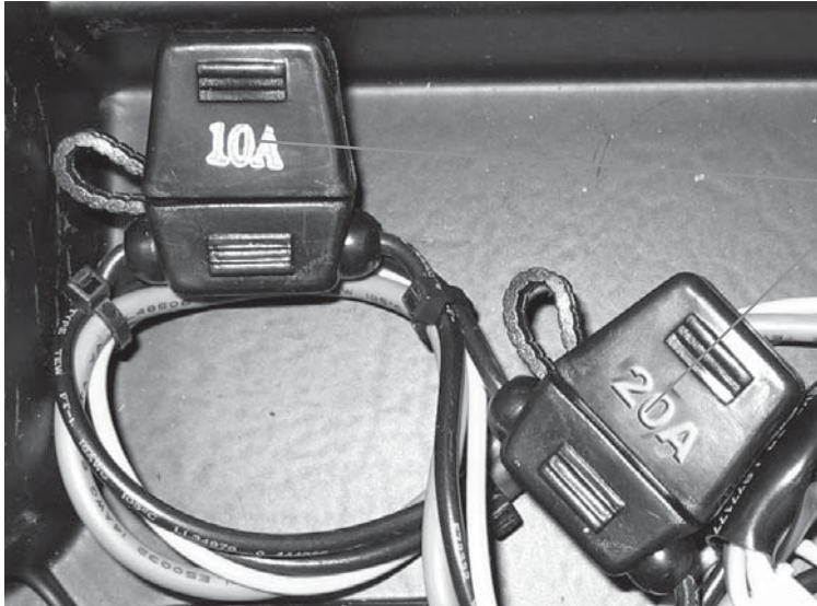
Figur 17 Bagskærmen løsnes. Plastik låget tages op ved at klemme på siderne. Nu kan der skiftes sikringer.
