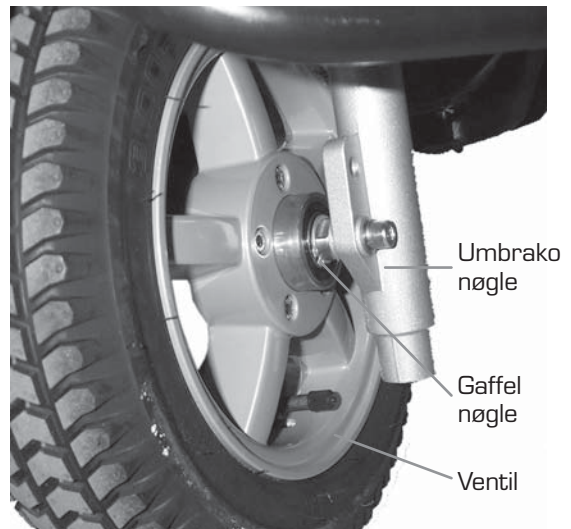
Figur 16 Fjern monteringsbolte med 17 mm gaffel og en umbrako nøgle 6 mm.
