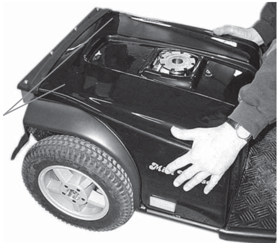
Figur 7B Skærmen trækkes frem mod styret, og kan derefter tages af.
