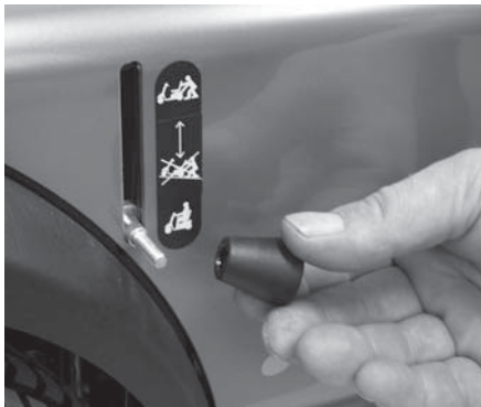
Figur 7A Knoppen til frikoplingshåndtaget drejes imod urets retning og tages helt af.
