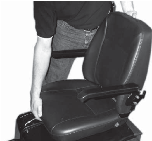
Figur 7 Sædet løftes op af sæderøret.
