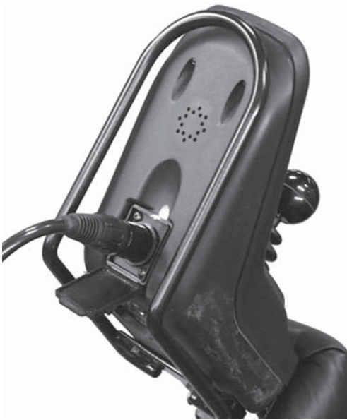
Figur 16 Ladestik forbindes til 3 polet stik på styrestolpe. Den hvide strek skal vende opad. Ladestikket er placeret under beskyttelsespladen.
