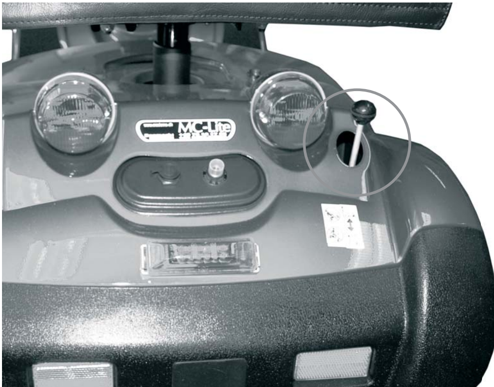
Figur 15 Frikoblingshåndtaget sidder ovenpå batteriskærmens højre side. Træk håndtaget op ad for at frikoble. Når køretøjet skal tilkobles igen, skal man trykke ned på håndtaget.
