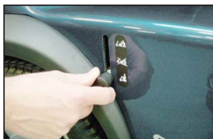
Knoppen til frikoplingshåndtaget drejes imod urets retning og tages helt af.
