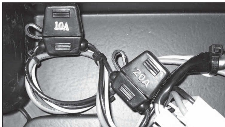
Bagskærmen løsnes. Plastik låget tages op ved at klemme på siderne. Nu kan der skiftes sikringer.
