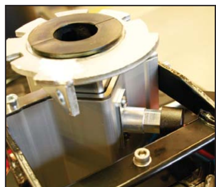
Sædeudløser trykket ud. Nu kan sæderøret løftes eller sænkes til ønsket højde. Tryk udløseren ind så den fanger et af de 5 huller der er i sæderøret.
