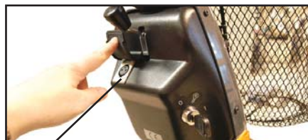
Ladestik forbindes til 3-polet stik på styrcammen. Ladesticket er placeret under beskyttelsespladen.
