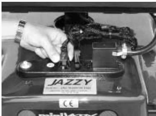
Figur 14 De 2 små sorte stik afmonteres ved at klemme på siderne.
