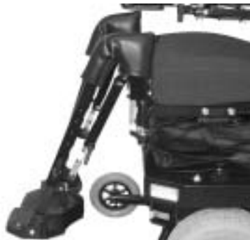
Figur 20 Dette billede er kun aktuelt, hvis der findes manuelle og el- benstøtter. Findes disse skal skruerne løsnes og benstøtterne vippes af. HUSK det skal gøres i begge sider.
