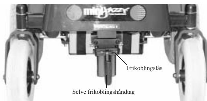
Figur 7 For at frikoble Mini Crosser Jazzy skal frikoblingslåsen trykkes ind, og derefter skal man trække op i selve frikoblingshåndtaget.
