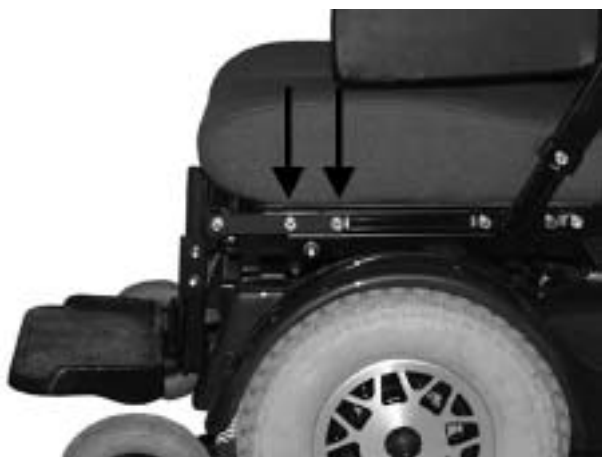
Figur 40 Fodpladen kan som det sidste justeres frem/tilbage. Dette gøres ved at løsne de 2 viste skruer. HUSK at efterspænde skrueerne ordentligt igen.
