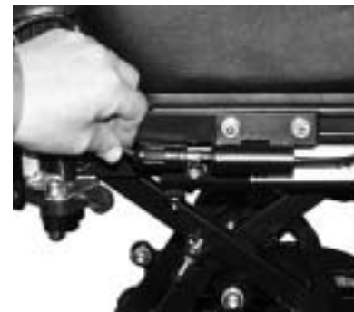
Figur 21 Dette billede er kun aktuelt, hvis der findes elbenstøtter. Findes disse skal dette stik tages ud. HUSK det skal gøres i begge sider.
