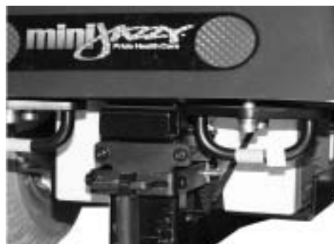
Figur 30 Bugseringsbeslagene bagtil sidder også under skærmen. Markeret med gult.
