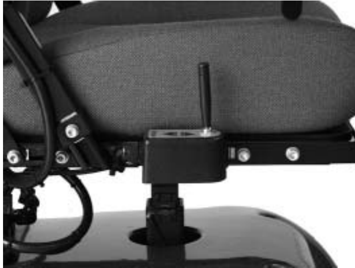
Figur 31 Sædehøjden reguleres ved at skubbe kontakten frem eller tilbage.
