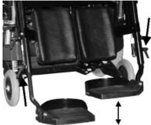
Figur 42 For at justere selve fodhvilerne op/ned skal kipspænderne som vist løsnes, og fodhvilerne kan justeres. Husk at spænde kipspændene ordentligt.
