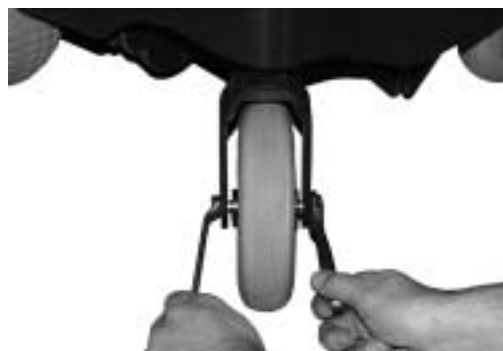
Figur 9 Støttehjulet (det bagerste): Den midterste skrue løsnes og tages ud. Ved påmontering skal man være opmærksom på at de 2 skiver, som sidder mellem hjulet og gafflen, skal på igen.
