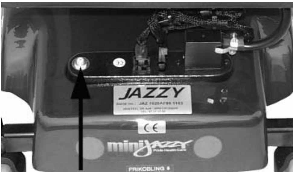
Figur 11 Thermosikringen ved Mini Crosser Jazzy 1103 Standard sidder under bagskærmen.
