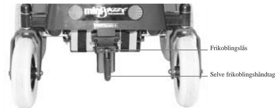
Figur 27 For at frikoble Mini Crosser Jazzy skal frikoblingslåsen trykkes ind, og derefter skal man trække op i selve fri koblingshåndtaget. For at slå drivenhederne til igen skal håndtaget trækkes ned igen.
