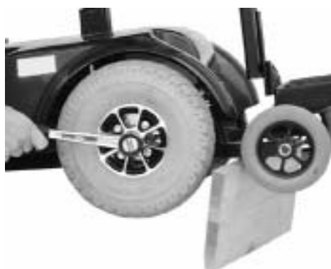
Figur 10 Centerhjulet: Den midterste skrue løsnes og tages ud. Hjulet kan nu vrikkes af.
