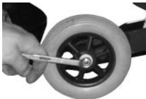
Figur 8 Sikkerhedshjulet (det forreste): Den midterste skrue løsnes og tages ud. Hjulet kan nu vrikkes af.
