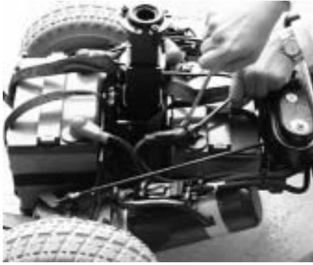
Figur 17 Plus- og minuspolerne skal afmonteres ved hjælp af værktøjer. Når dette er klaret kan batterierne skiftes.
