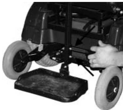
Figur 39 For at justere selve fodpladen op/ned skal skrueerne som vist løsnes. Juster fodpladen op/ned og HUSK at skrue skrueerne ordentligt fast igen.
