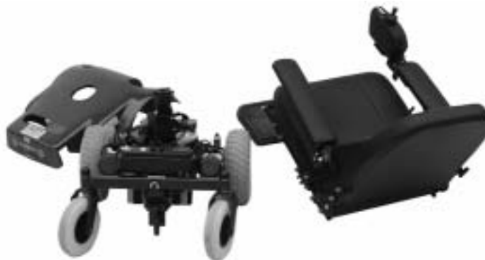
Figur 16 Sædet og skærmen kan løftes op uden brug af værktøj
