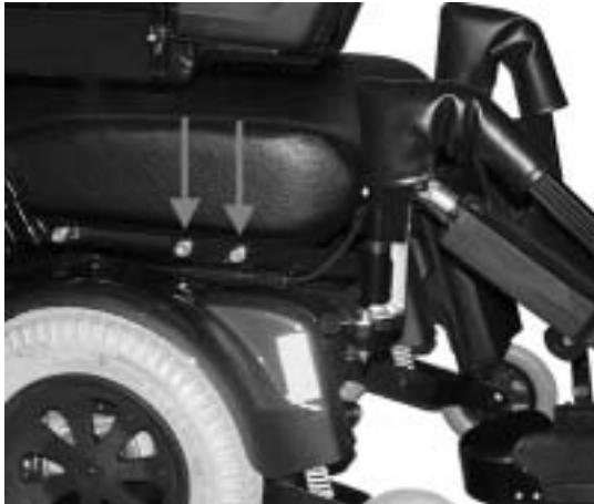
Figur 41 Fodstøtterne kan justeres frem/tilbage. Dette gøres ved at løsne de 2 viste skruer. HUSK at efterspænde skruerne ordentligt igen.
