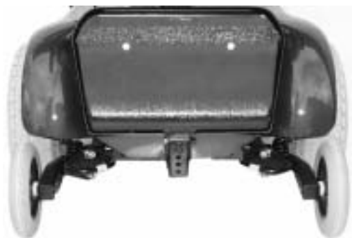
Figur 29 Bugseringsbeslagene fortil sidder under skærmen. Markeret med gult.
