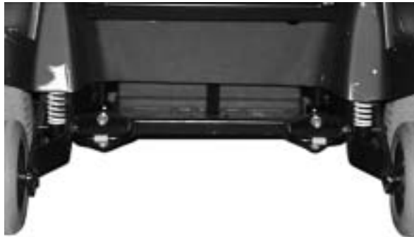
Figur 28 Det ene sæt bugseringsbeslag sidder lige under skærmen fortil.
