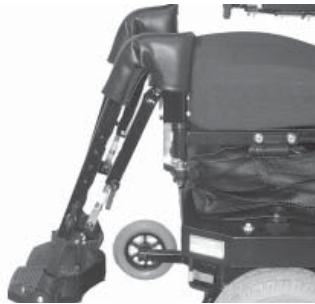
Figur 19 Dette billede er kun aktuelt, hvis der findes manuelle benstøtter. Skruerne løsnes og benstøtterne vipres af. HUSK det skal gøres i begge sider.
