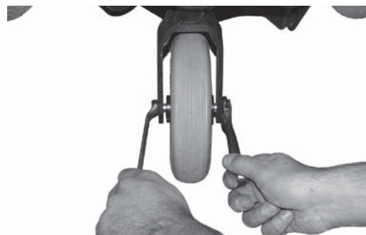
Figur 9 Støtتهjulet (det bagerste): Den midterste skrue løsnes og tages ud. Ved påmontering skal man være opmærksom på, at de 2 skiver, som sidder mellem hjulet og gafflen, skal monteres igen (Mini Crosser Jazzy 1120)
