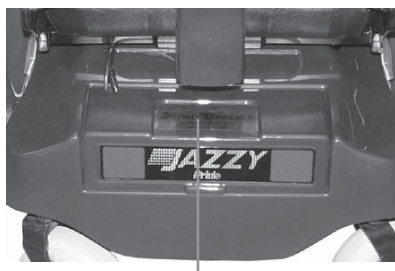
Figur 16 Dette er dækslet, som kan løftes op og tages helt af, da det „kun“ sidder fast med velcrobånd.
