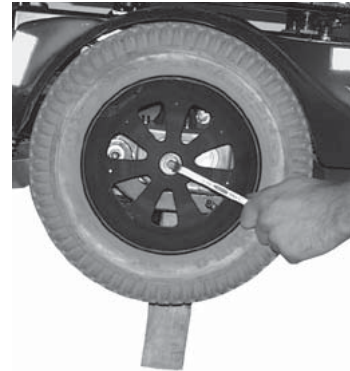
Figur 11 Centerhjulet: Den midsterste møtrik løsnes og tages ud. Hjulet kan nu vrikkes af.
