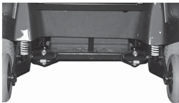
Figur 26 Bugseringsbeslagene fortil sidder under skærmen.
