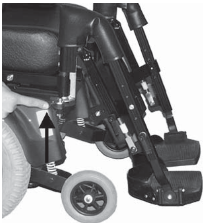
Figur 45 Fodstøtterne kan svinges til siden. Dette gøres ved at trykke ind på det viste sted med fingeren.
