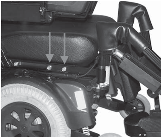
Figur 42 Fodstøtterne kan justeres frem/tilbage. Dette gøres ved at løsne de 2 viste skruer. HUSK at efterspænde skruerne ordentlig igen.
