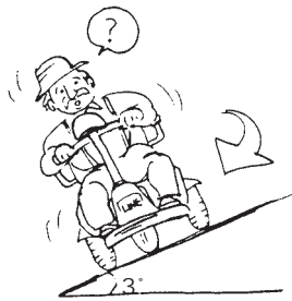
Figur 15 Kør ikke på skrån timer med større sidehældning end 3°.
