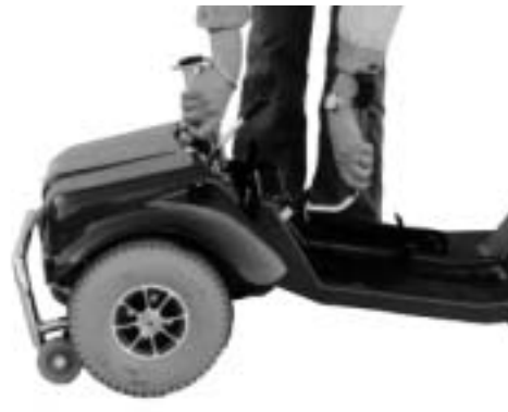
Figur 32 Knæk køretøjet. Tag fat om sæderøret og styrholderbøjlen. Vip sæderøret bagover.
