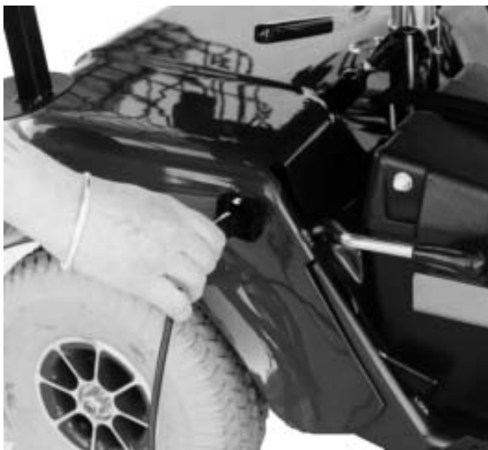
Figur 23 Den hvide streg på bagskærmen skal passe med den hvide streg på ladestikket. Stikket sidder på højre side af køretøjet.
