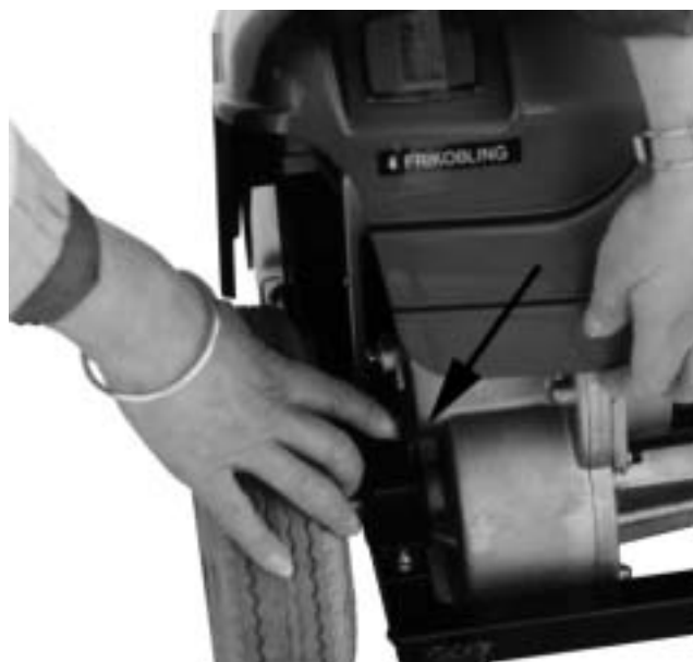
Figur 26 Her på LINETTE sidder håndtaget i venstre side, når man står bag køretøjet
