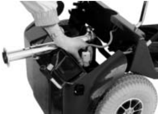
Figur 33 Hovedkablet under bagskærmen tages ud. Når stikket er taget ud kan man tage fat i styrholderbøjlen og skille forende fra bagende ved at løfte i denne bøjlen.
