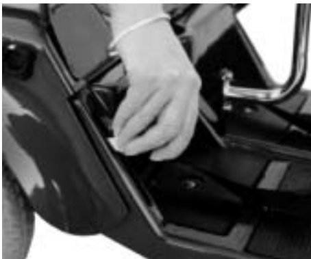
Figur 31 Låsehåndtagene på begge sider af køretøjet skal skubbes op til UNLOCK position.
