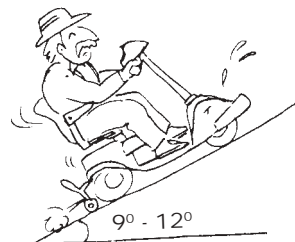
Figur 14 LINE kan klare en stigning på max. 12°. LINETTE kan klare en stigning på max. 9°.
