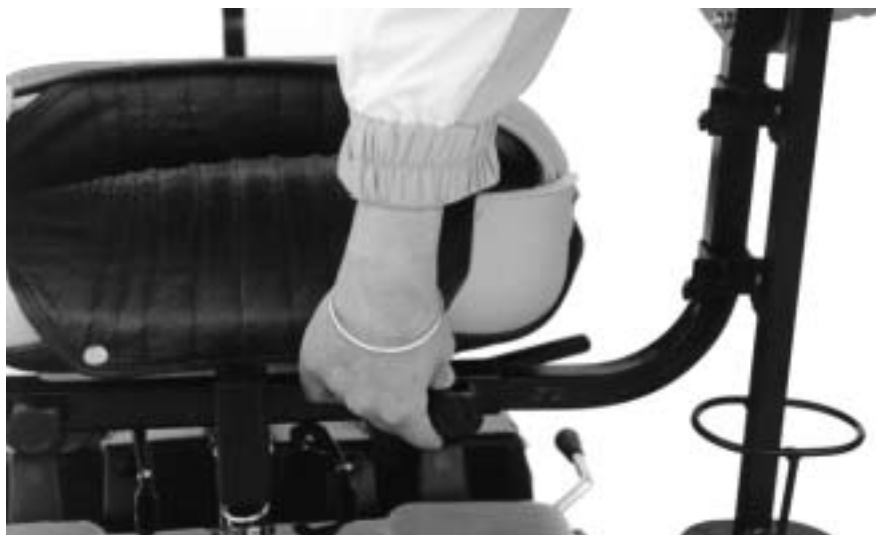
Figur 5 Fingerskruen sidder både bag og under sædet, derfor er det bedst at stå bag ved køretøjet når armlænen skal reguleres.
