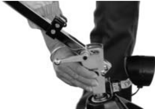
Figur 34 Styrstangen lægges ned. Sæt styret fast på styrholderbøjlen.
