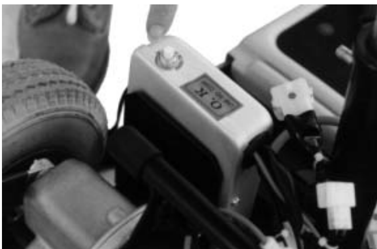
Figur 22 Løft sædet og bagskærmen af. Den ene sikringsknap som findes vil nu kunne ses.
