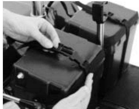
Figur 30 Afmonter batterierne. Batteriremmene løsnes i begge sider. Tag derefter fat i stofhåndtagene og batterierne kan løftes.
