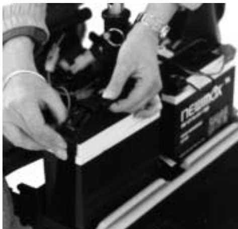
Figur 37 Afmontér batterierne. Batteriremmene løsnes i begge sider, og derefter kan batterierne fjernes.
