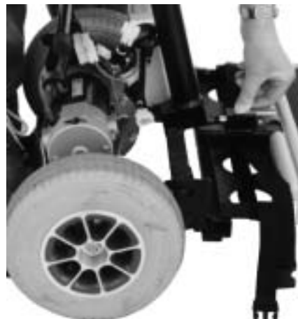
Figur 38 Splitten trykkes ned og derefter kan bagenden knækkes fra forenden.
