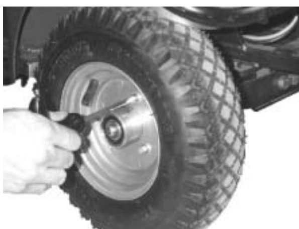
Figur 15 Afmonterer de 3 skruer, 5 mm unbrako nøgle. Hjulet kan nu tages af.
