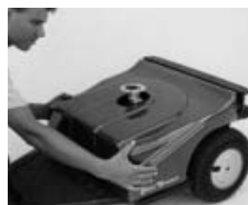
Figur 6 Skærmen trækkes frem mod styret, og kan derefter tages op.
