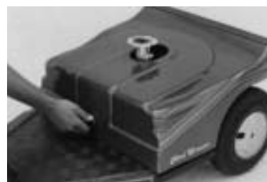
Figur 3 Fingerskruen på forsiden af bagskærmen drejes imod urets retning og tages helt af.
