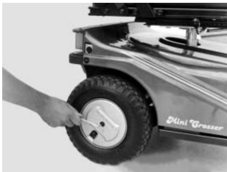
Figur 11 Hjulcapslen tages af. Dette gøres ved at demontere skruen i midten af hjulet.
