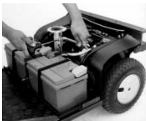
Figur 7 De 2 skruer på sæderøret løsnes.
