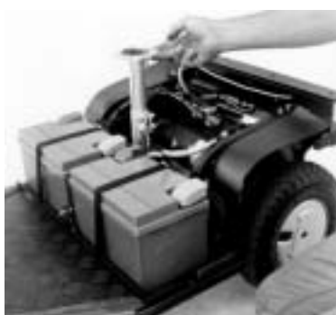
Figur 8 Sæderøret kan nu trækkes op / skubbes ned alt efter behov. Sæderør må ikke trækkes længere op end angivet med vandret rille på sæderøret.
