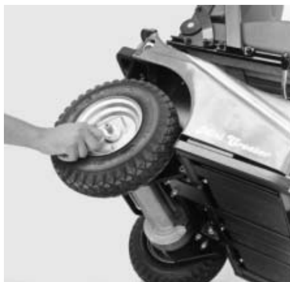
Figur 12 På dette billede ses de 3 skruer som skal af. Derefter kan hjulet tages af. Ved genmontering skal fjederskiverne monteres mellem hjulfælg og skrue. Skrueerne skal spændes godt til.
