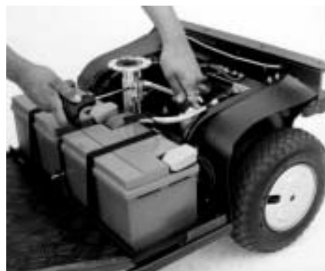
Figur 6 De 2 skruer på sæderøret løsnes.
