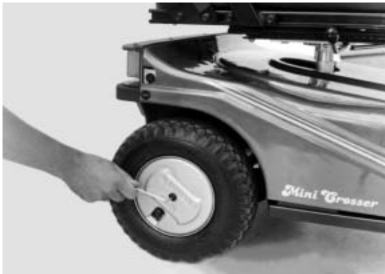
Figur 12 Hjulcapslen tages af. Dette gøres ved at demontere skruen i midten af hjulet.
