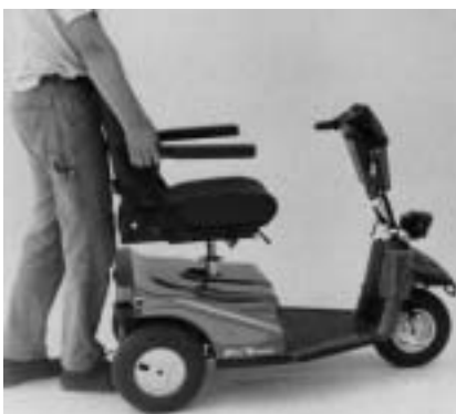
Figur 3 Sædet løftes op af sæderøret.
