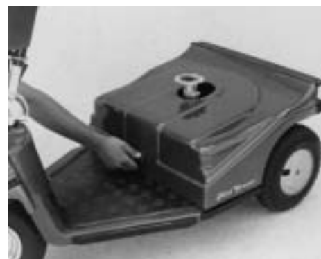
Figur 4 Fingerskruen på forsiden af bagskærmen drejes imod urets retning og tages helt af.
