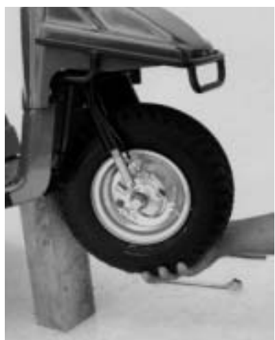
Figur 18 Påmontering af forhjul
