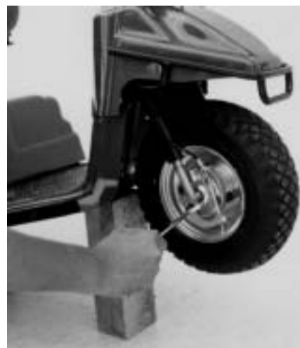
Figur 15 Skruene på begge sider af hjulet løsnes og tages ud.
