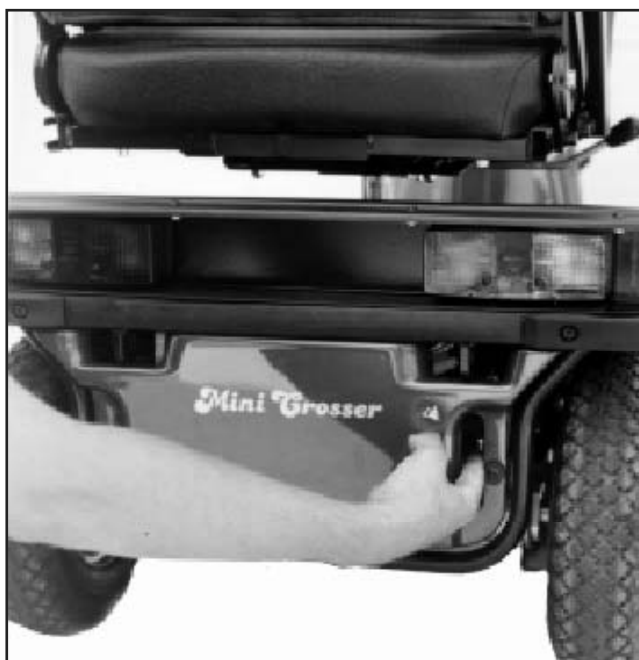
Figur 21 Skub håndtaget ned ved frikobling, og køretøjet kan skubbes. Skub håndtaget op for aktivering af motor (Standardstilling). Håndtaget skal kun ned, når køretøjet skal skubbes. Når bugsering er tilendebragt, skubbes frikoblingshåndtaget op igen. Nu er køretøjet bremsat og kan køre normalt.
