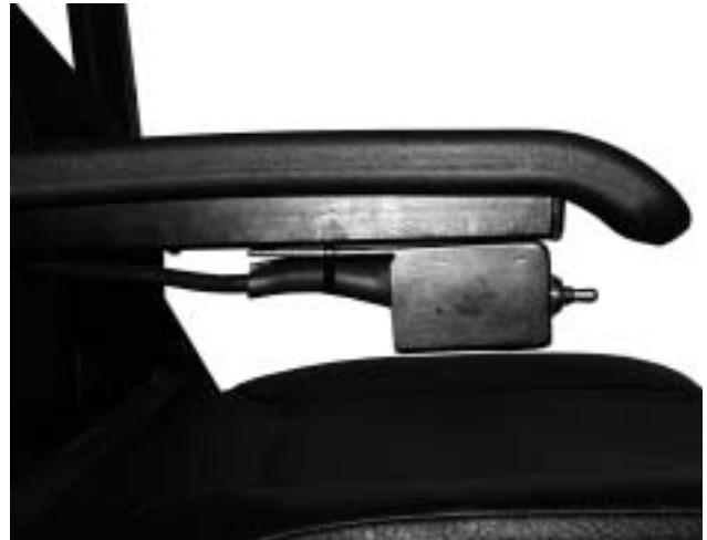
Figur 8 El-sæde løft. Føres knappen op, løftes sædet. Føres knappen ned, sænkes sædet.
