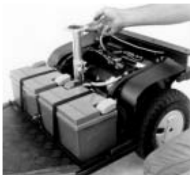
Figur 7 Sæderøret kan nu trækkes op / skubbes ned alt efter behov. Sæderør må ikke trækkes længere op end angivet med vandret rille på sæderøret.
