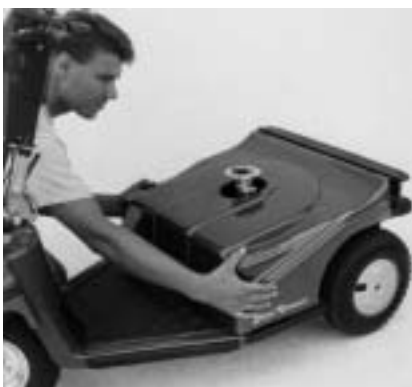
Figur 5 Skærmen trækkes frem mod styret, og kan derefter tages op.
