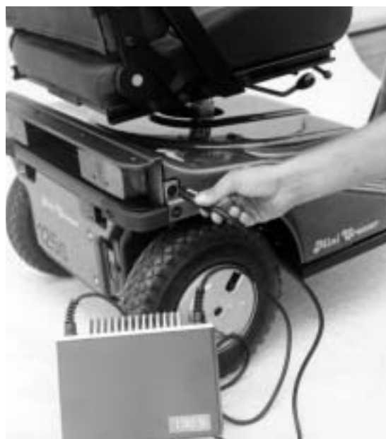
Figur 20 Når stikket ved opladeren skal i køretøjet, skal den hvide streg vende opad.
