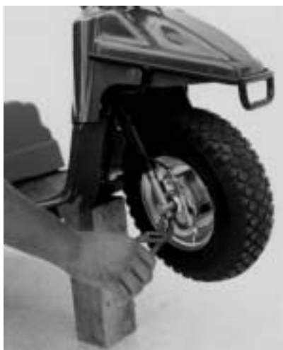
Figur 14 Boltene på begge sider afsikres. Dette gøres ved at rette låse blikket ud til vandret stilling.
