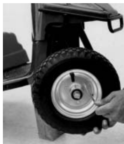
Figur 17 De 3 skruer tages ud. Hjulet kan nu skiftes.
