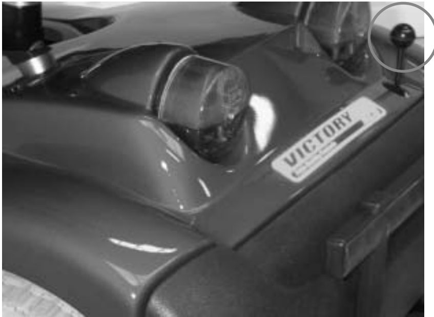
Figur 26 Frikoblingshåndtaget sidder ovenpå bagskærmens højre side. Træk håndtaget op ad for at frikoble. Når køretøjet skal tilkobles igen, skal man trykke ned på håndtaget.
