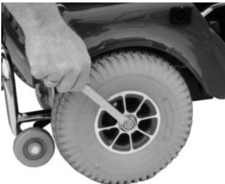
Figur 23 Møtrikken løsnes og skrues af.
