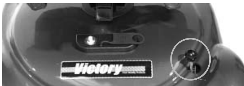
Figur 22 Frikoblingshåndtaget sidder ovenpå bagskærmens højre side. Træk håndtaget op ad for at frikoble. Når køretøjet skal tilkobles igen, skal man trykke ned på håndtaget.
