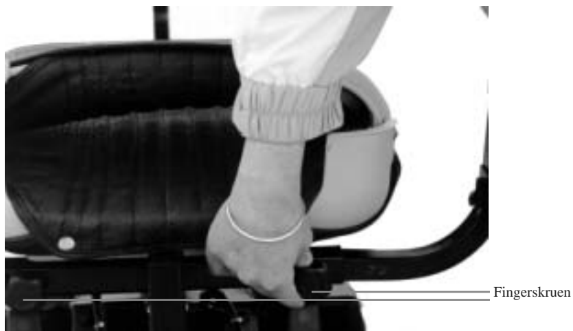
Figur 5 Fingerskruen sidder både bag og under sædet, derfor er det bedst at stå bag ved køretøjet når armlænene skal reguleres.
