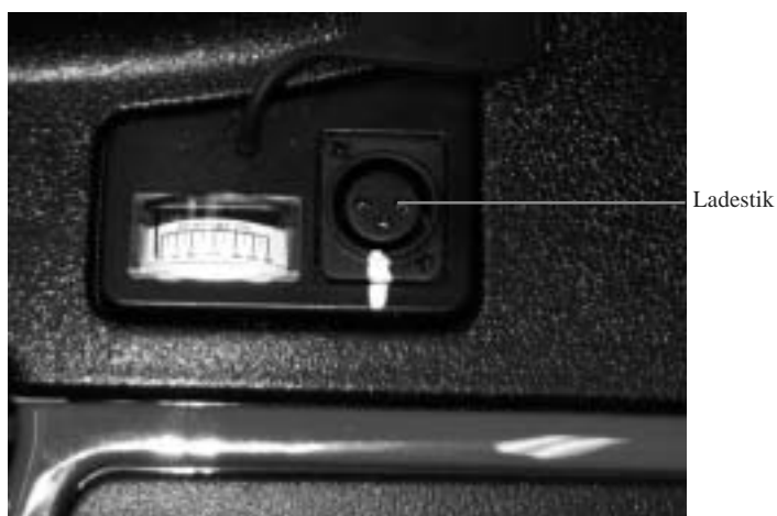
Figur 21 Den hvide streg på Mini Crosser Sonic ladestik skal passe med hvid streg på ladestikket. Stikket sidder til højre under sædet.
