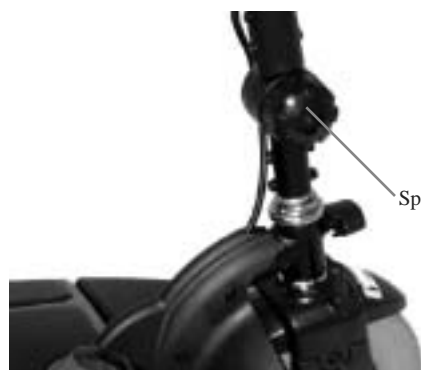
Figur 31 Spændegreb løsnes, styret lægges ned.
