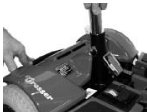
Figur 28 Hold fast i sæderøret. Tryk ned på kofangeren. Sæderøret vil da bevæge sig i vandret stilling.
