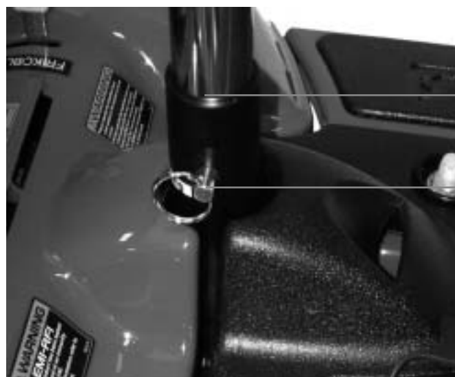
Figur 4 Sæderøret reguleres ved at løsne splitten. Når sæderøret er sat i den ønskede højde, HUSK da at sætte splitten ordentlig på igen.
