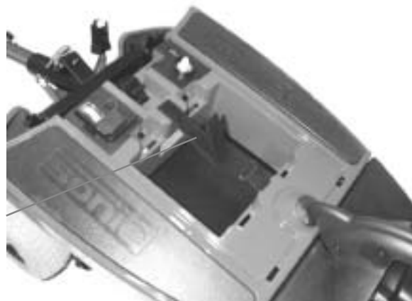
Figur 30 Batteriremmen åbnes, batterierne fjernes.
