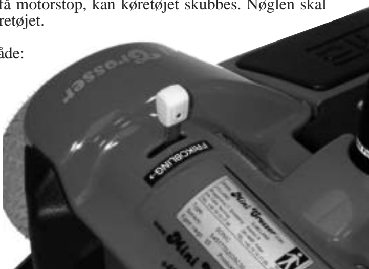
Figur 22 Frikoblingshåndtaget sidder ovenpå bagskærmens venstre side. Træk håndtaget tilbage for at frikoble. Når køretøjet skal tilkobles igen, skal man trykke håndtaget frem.
