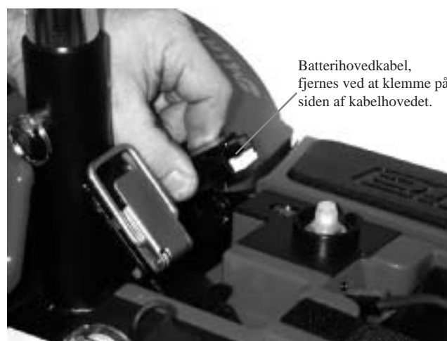
Figur 26 Batterikabel afmonteres i bagende
