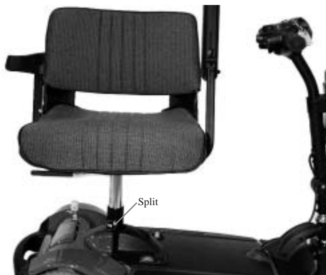
Figur 3 Drej sædet, stil Dem bag ved køretøjet, og træk op i ryglænet, derved vil stolen gå fri af sæderøret.
