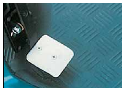
Fodgasregulering Kan monteres i højre eller venstre side. Til M-modeller og MaxX. T-127-06-116
