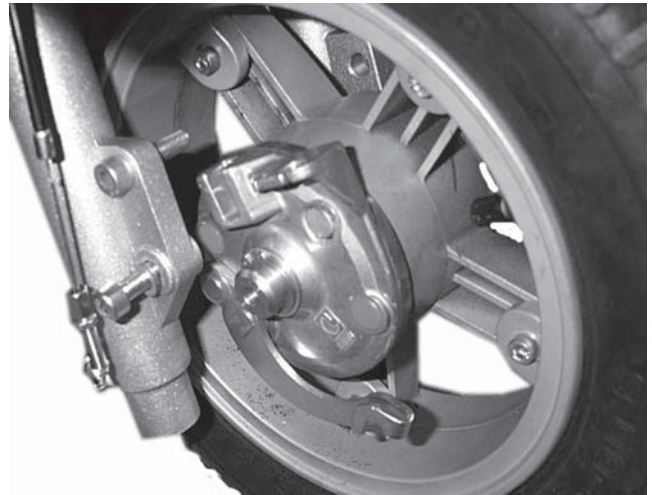
Figur 19 Montering af forhjul. Vær opmærksom på at bremse kaliber placeres i stopskruen øverst.
