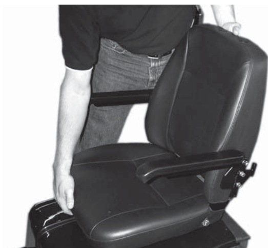
Figur 5 Sædet løftes op af sæderøret.
