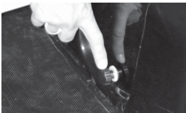
Figur 6 Fingerskruen på forsiden af bagskærmen drejes imod urets retning og tages helt af.
