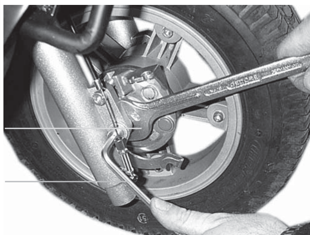
Figur 16 Fjern monteringsbolte med 17 mm gaffel og en umbrako nøgle 6 mm.
