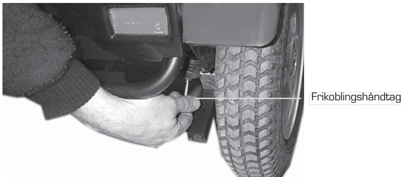
Figur 22 Skub håndtaget ned ved frikobling, og køretøjet kan skubbes. Træk håndtaget tilbage for aktivering af motor (Standardindstilling) Håndtaget skal kun ned, når køretøjet skal skubbes. Når bugsering er tilendebragt, trækkes frikoblingshåndtaget op igen. Nu er køretøjet bremsat og kan køre normalt.
