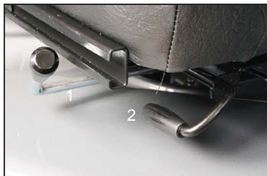
1. Udløserhåndtag for sædedrej. 2. Udløserhåndtag for sæde frem/tilbage.
