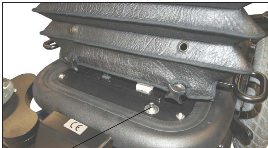
Her sidder termosikringen.
